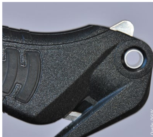
Abbildung 4: Kopf eines Folienmessers mit verdeckter Klinge
