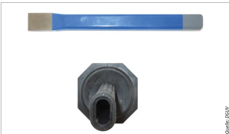
Abbildung 5: Meißel mit Handschutz: profilierter Griff mit achtkantigem Handschutzteller
