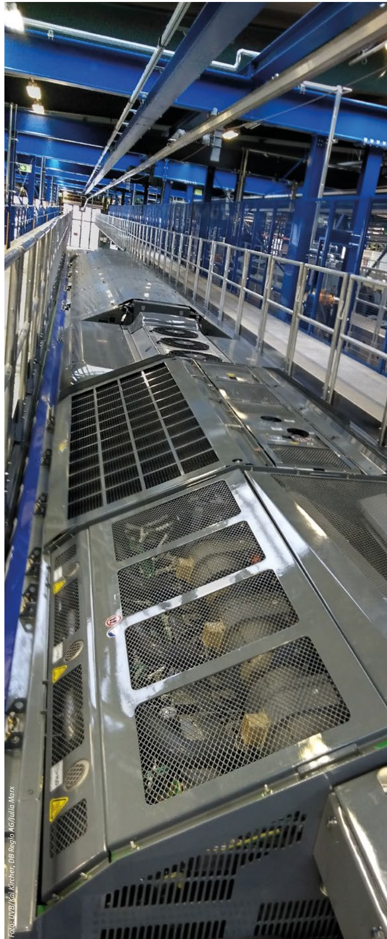
Abbildung 1: Brennstoffzellen- und Wasserstoffkomponenten auf dem Zugdach.
