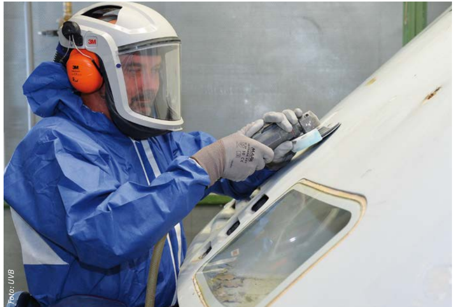
Abbildung 1: Handschleifmaschine im Einsatz
