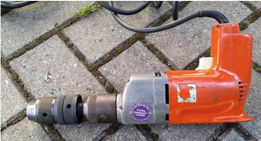
Abbildung 6: Arbeitsmittel Bohrmaschine mit Prüfplakette
