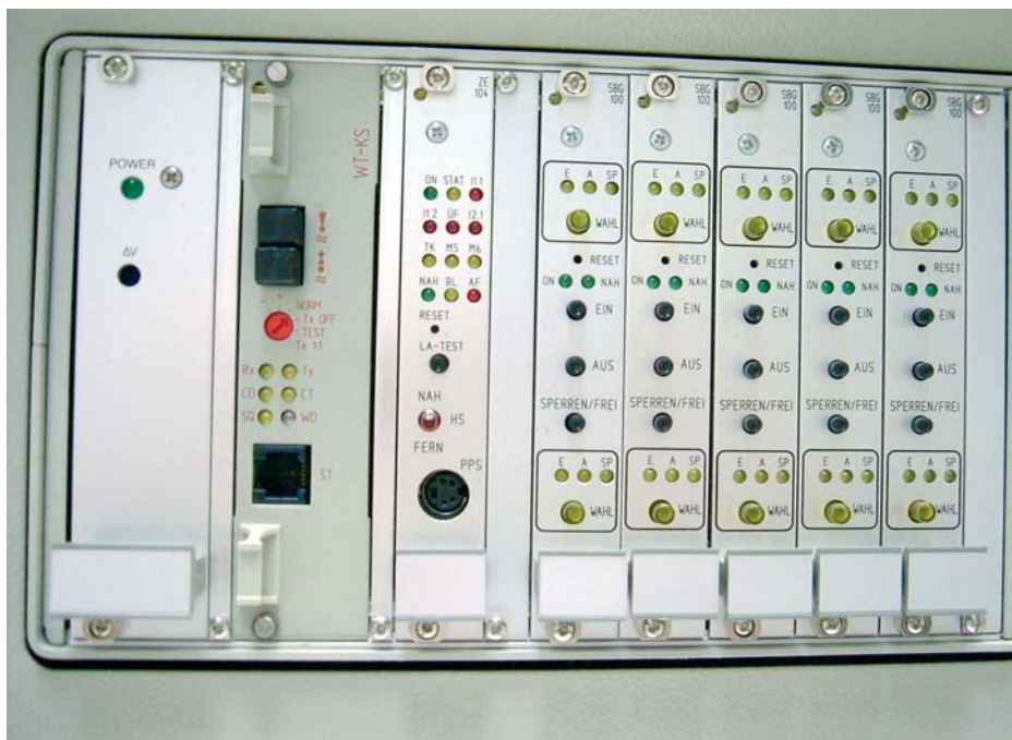
Abbildung 5: Ortssteuerung mit Drucktasten auf den Mastschalterkarten.
