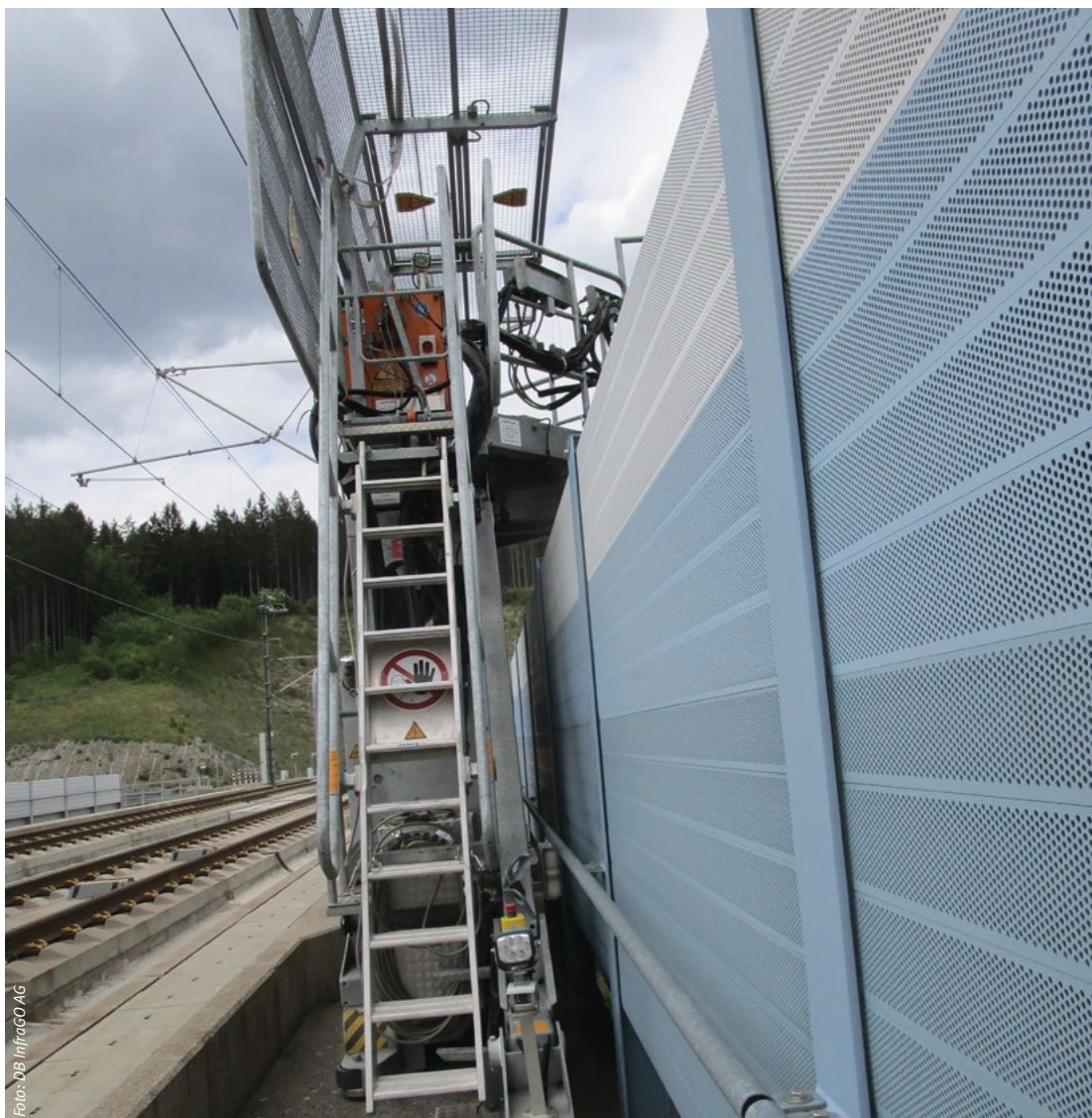
Abbildung 1: Fahrzeug/Oberbau als Zugang zum Brückenuntersicht- gerät – seitlich neben dem Gleis
