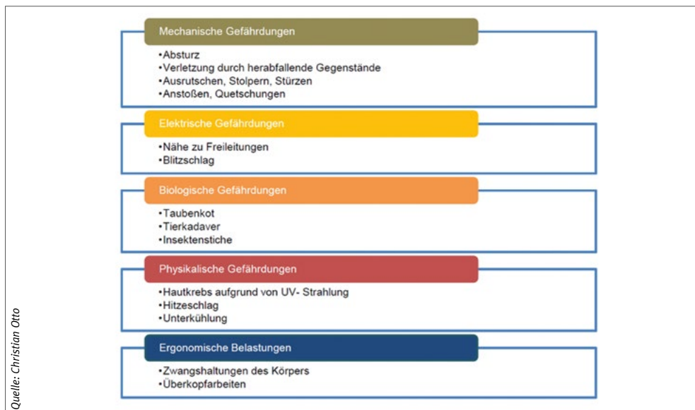
Abbildung 3: Zusammenstellung möglicher Gefährdungen bei Arbeiten auf Brückenuntersichtgeräten
