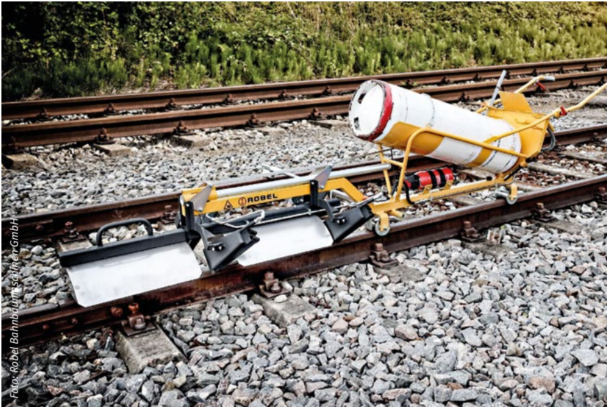
Abbildung 3: Die Wärmeröhre als Werkzeug
