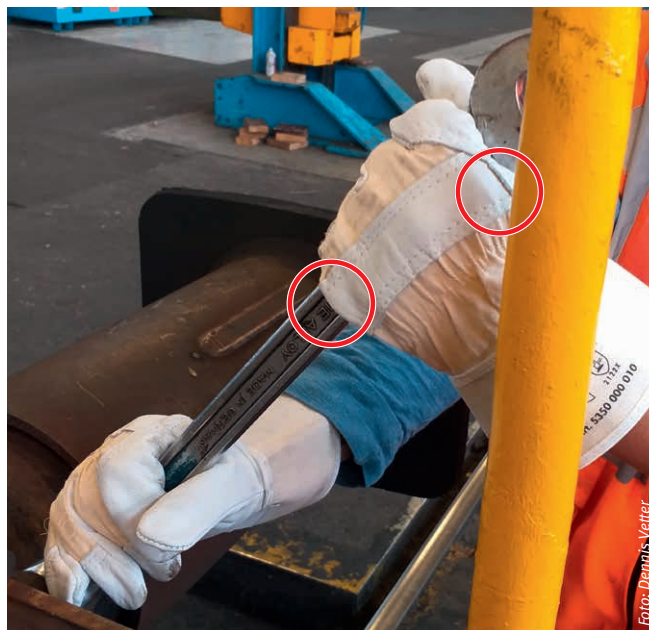
Fehlender Anstoßschutz beim Handschuh
