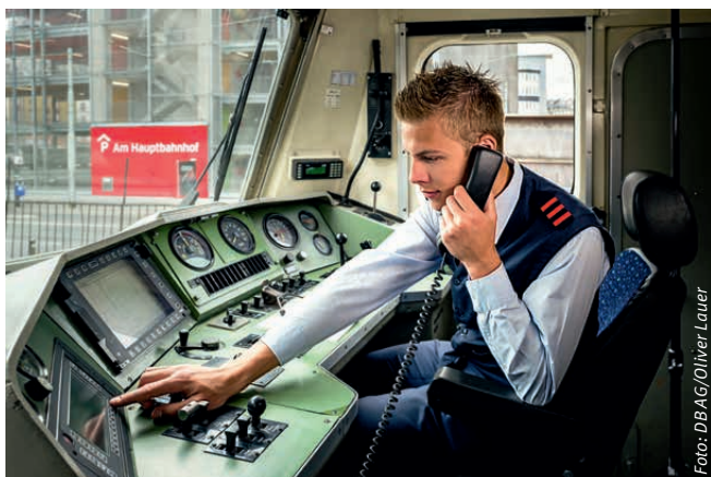
Tf bedient Zugfunkgerät im Führerraum
