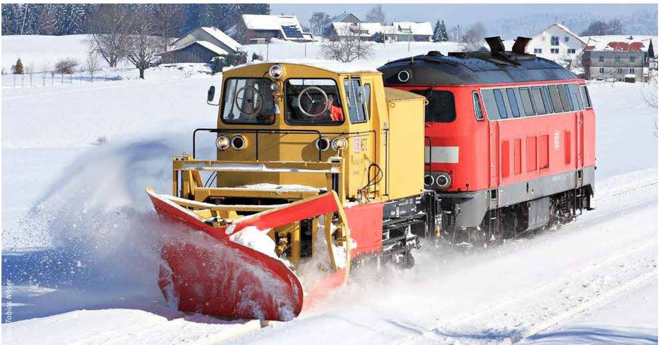
Schneepflug der BA 753, geschoben von einer BR 218, im Einsatz bei Röthenbach/Allgäu
