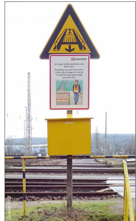
Abbildung 8: Warnzeichen „Warnung vor Gefahren durch eine Förderanlage im Gleis“ (D-W029)
