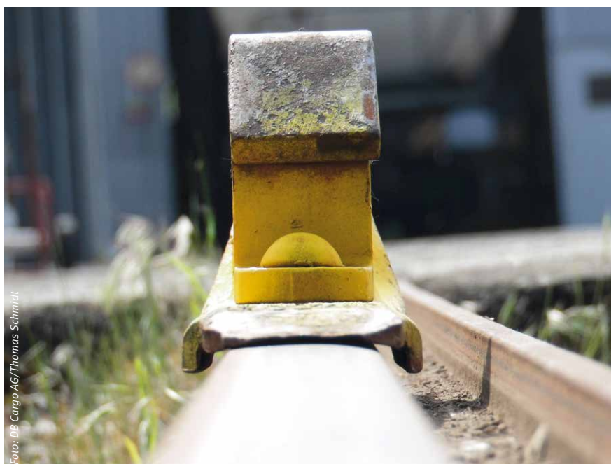
Ein bei der Zugvorbereitung vergessener Hemmschuh kann zu einem gefährlichen Ereignis im Bahnbetrieb führen
