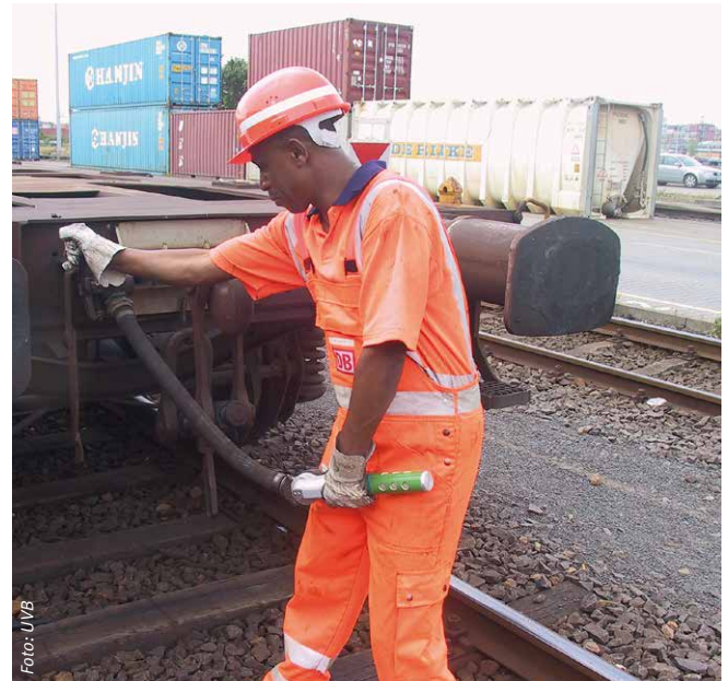
Abbildung 5: Tragbare Schalldämpfer verringern die Lärmbelastung bei der Durchgangsprüfung der Hauptluftleitung
