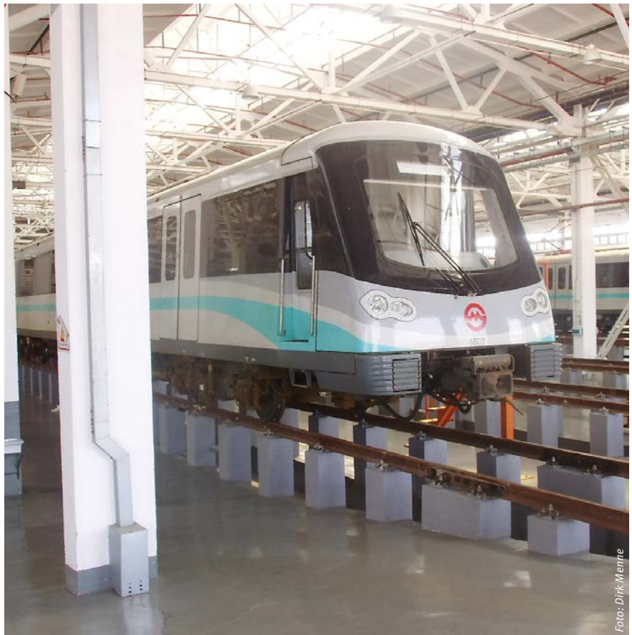
Die Fahrzeuge der Metro line 16 in Shanghai sind für den automatischen Betrieb ausgelegt, Bedingung dafür ist ein Einhalten der Bremswege unter allen Umständen.
