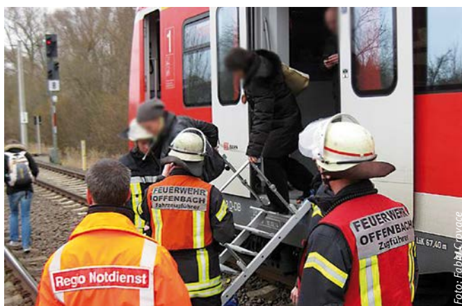
Der Evakuierungssteg (hier als Leiter im Einsatz) ermöglicht die zügige Evakuierung auf freier Strecke
