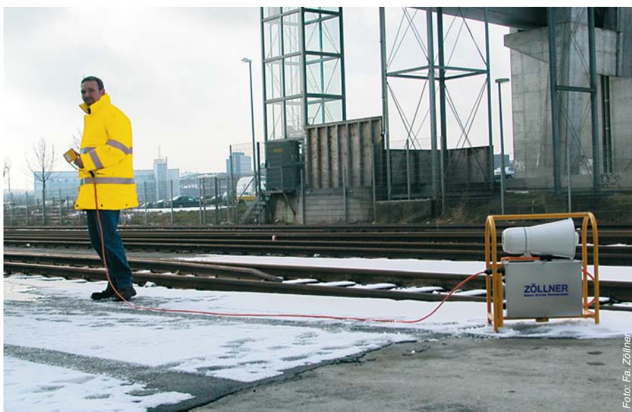
Abbildung 5: Elektrischer Warnsignalgeber WGH D/2 E der Fa. Zöllner, Kiel, als Tyfonersatz.
