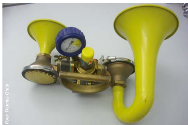
Abbildung 4: Druckgasbetriebenes Tyfon, Aufsatz.
