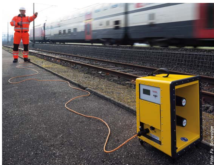
Abbildung 6: Elektrischer Warnsignalgeber AW 126-LT der Fa. Schweizer, Reiden, als Tyfonersatz. Das Foto wurde in der Schweiz aufgenommen.
