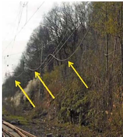
Durch gestohlenen Rückankerseil hängt die Oberleitung durch, Folgeschäden können auftreten
