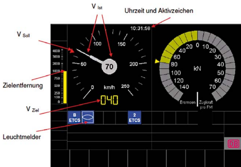
Abbildung 7: Darstellung der Führungsgrößen im Ttz bei ETCS L2
