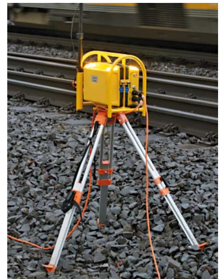
ZPW, funkangesteuerter Warngeber, bis zu zwei Starktonhörner anschließbar. (Werkfoto der Fa. ZÖLLNER Signal GmbH)
