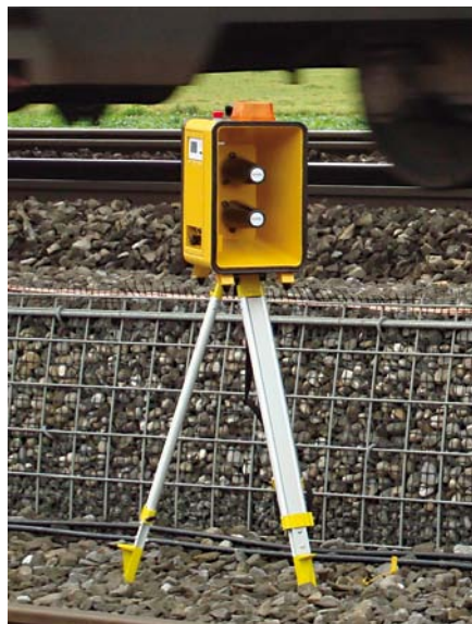
Funkgesteuerter Warnsignalgeber Minimet EWK-L. (Werkfoto der Fa. Schweizer Electronic AG)
