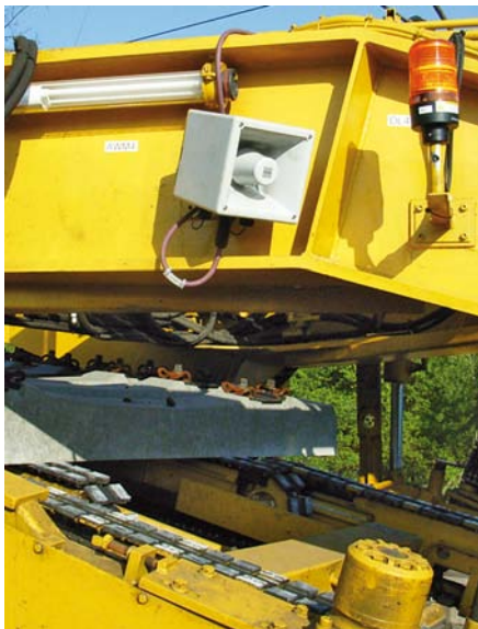
Bestandteil eines maschineneigenen Warnsystems auf einem Gleisumbauzug. (Foto: Archiv EUK)
