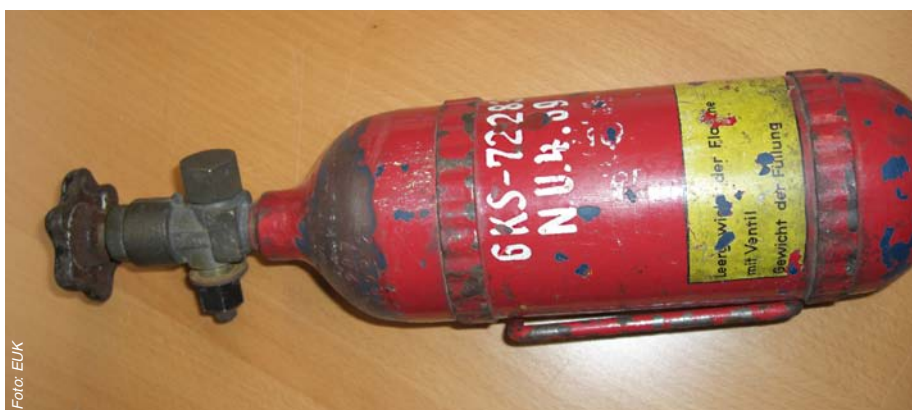
Abbildung 6: Eine wiederbefüllbare Handwerkerflasche ist sehr robust und hält einem Prüfdruck von über 200 bar stand. Sie ist für den Einsatz auf Baustellen gut geeignet.
