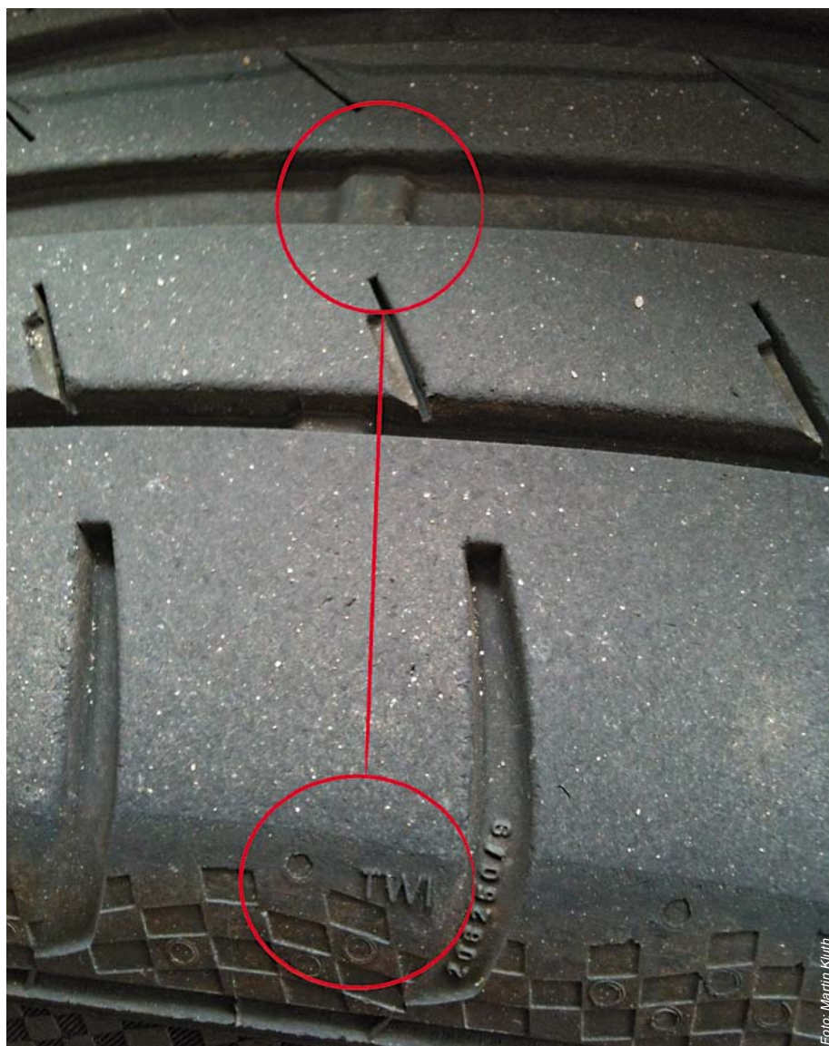
Abbildung 2: TWI – Tread Wear Indicator (Sommerreifen)
