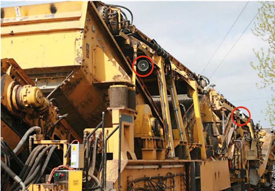
Abbildung 5: Warnsignalgeber einer Maschinenwarnanlage montiert auf einer Gleisbaumaschine
