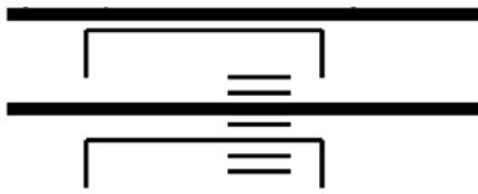
Typ 2: Absperrung durch Ketten, hier Typ 2h (Kette hinten)
