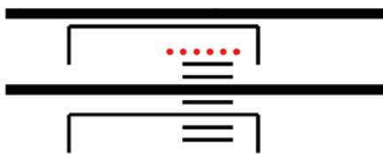
Typ 3: Absperrung durch Schranke, hier Typ 3m (Schranke zwischen den Gleisen)
