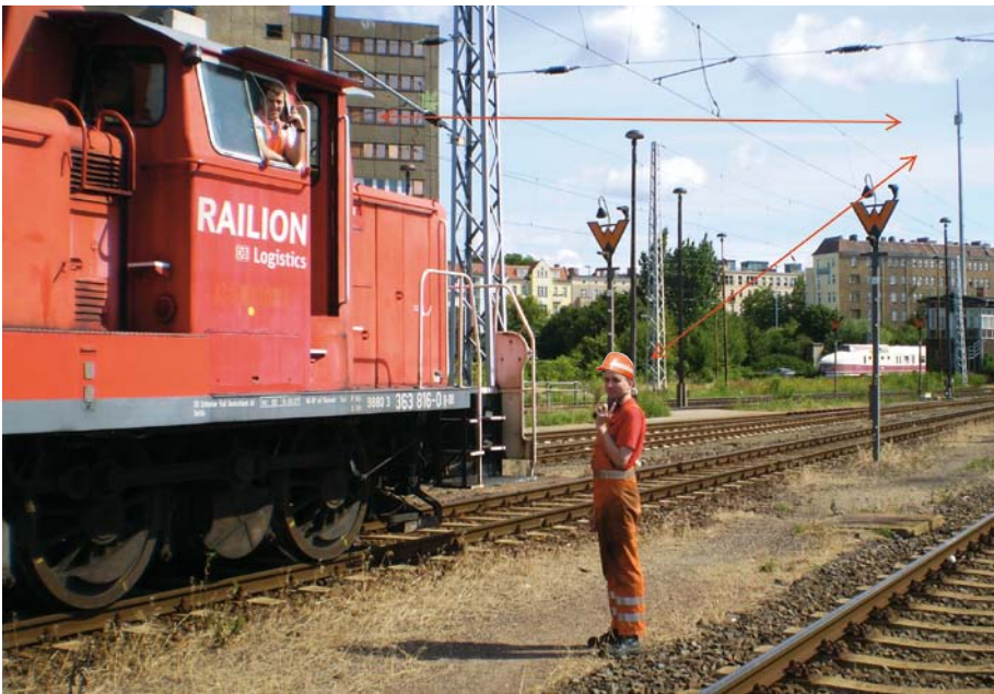
Abbildung 2: GSM-R-Verbindungen mit mobilen Teilnehmern führen immer über den nächstgelegenen Funkmast, selbst wenn die Teilnehmer unmittelbar nebeneinander stehen (Foto: Frank Hebel)
