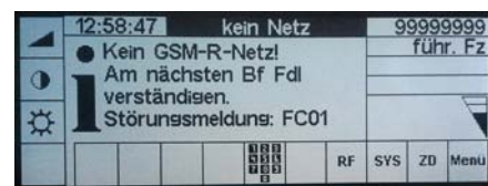
Abbildung 4: Displaybild am Zugfunk-Fahrzeuggerät bei Funknetzausfall (Foto: Holger Lietz)
