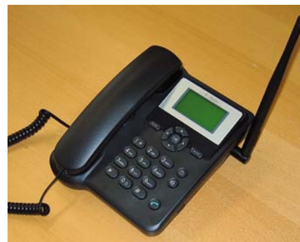
Abbildung 5: Bei der DB AG häufig verwendetes drahtloses Rückfalltelefon (Foto: Uwe Freydzank)
