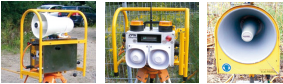
Abbildung 3: Warnsignalgeber WGH 95/0, ZPW 120 (beide Fa. Zöllner); AW 21/126 (Fa. Schweizer) (Fotos: BG BAU)
