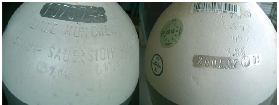
Abbildung 1: Die Prägung auf einer Gasflasche gibt Auskunft über Inhalt (Sauerstoff), Füllmenge (50 Liter) und Prüffdaten (alle 10 Jahre seit 1975).
