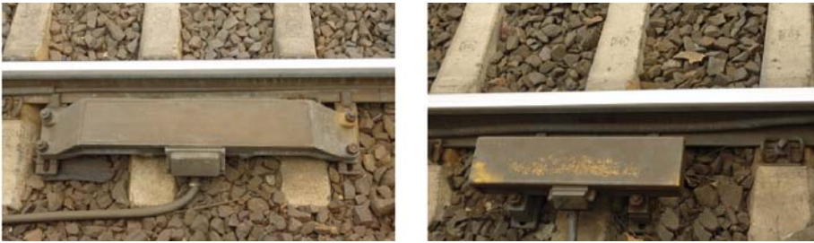
Abbildung 1: Im Vergleich 500 Hz Gleismagnet (links) und 2000 bzw. 1000 Hz Gleismagnet (rechts)
