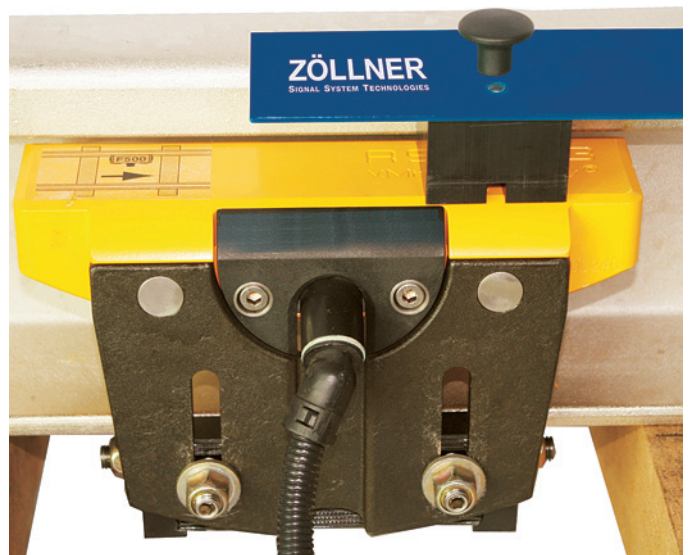
Abbildung 3: Kontrolle der Montage und Funktionalität mit der Prüfllehre.
