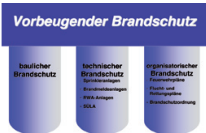
Abbildung 2: Die drei Säulen des vorbeugenden Brandschutzes.
