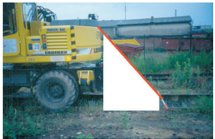
Abbildung 3, oben: Erhebliche Sichteinschränkung nach hinten ohne Kamera-Monitor-System.
