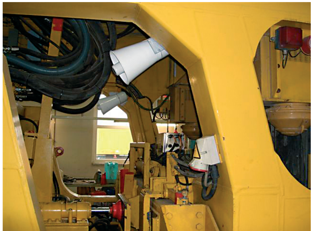
Abbildung 2: Fest auf der PVM RPMW 2002-2 der GBM Wiebe GmbH installierte Warnsignalgeber.
