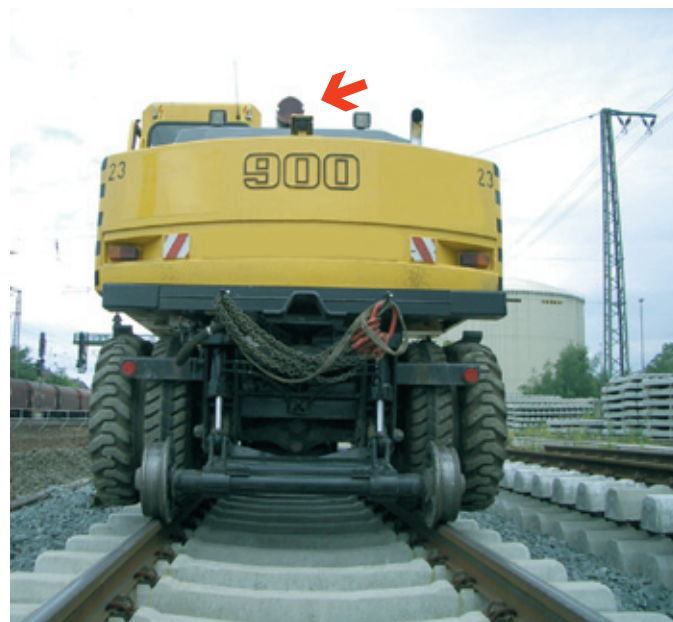
Abbildung 1, rechts: Eingeleisteter Zweibein-Bagger mit Kamera auf dem Oberwagen.
