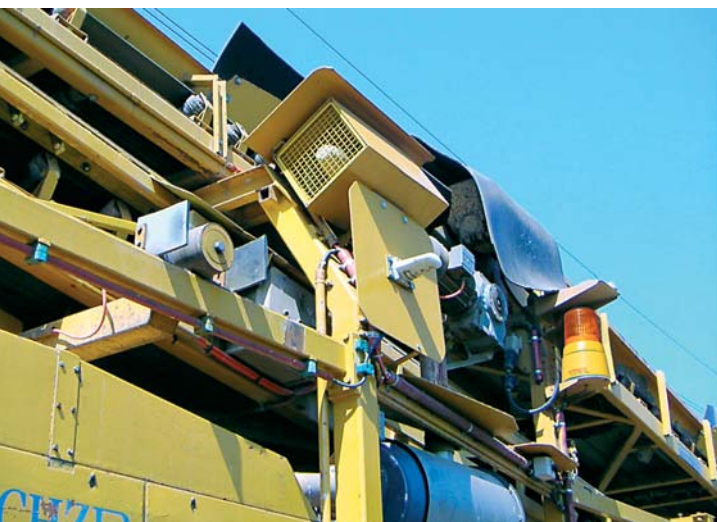
Abbildung 15: Warnanlagen auf Gleisbaumaschinen. Links: im europäischen Ausland (Hersteller Schweizer), rechts: auf einem Umbauzug (Hersteller Zöllner).
