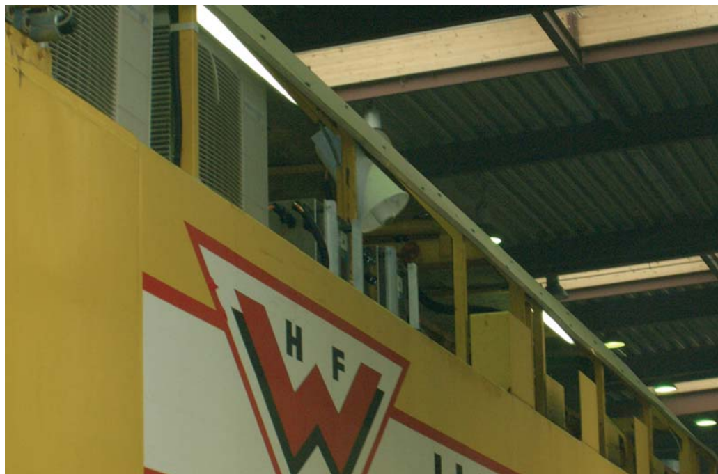
Abbildung 2: Akustischer Signalgeber der Maschinenwarnanlage auf der RPMW 2002-2.
