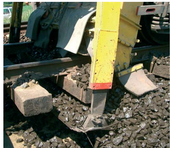
Abbildung 11: Planumsverbesserungsmaschine: Geräuschverteilung an der Einschotterung (links [18]) und Schotterauslass (rechts).
