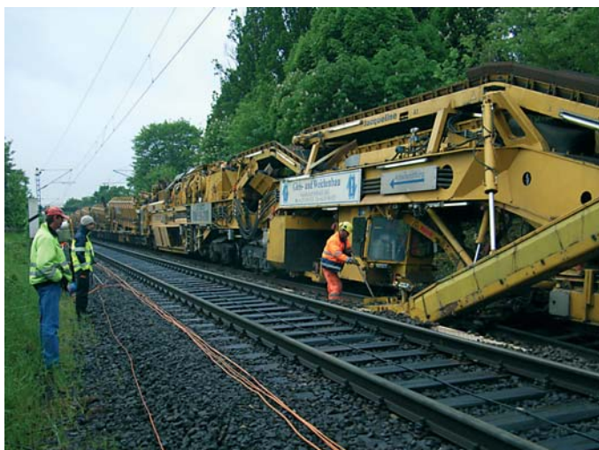
Abbildung 3: Störungsbeseitigung an einer Bettungsreinigungsmaschine.
