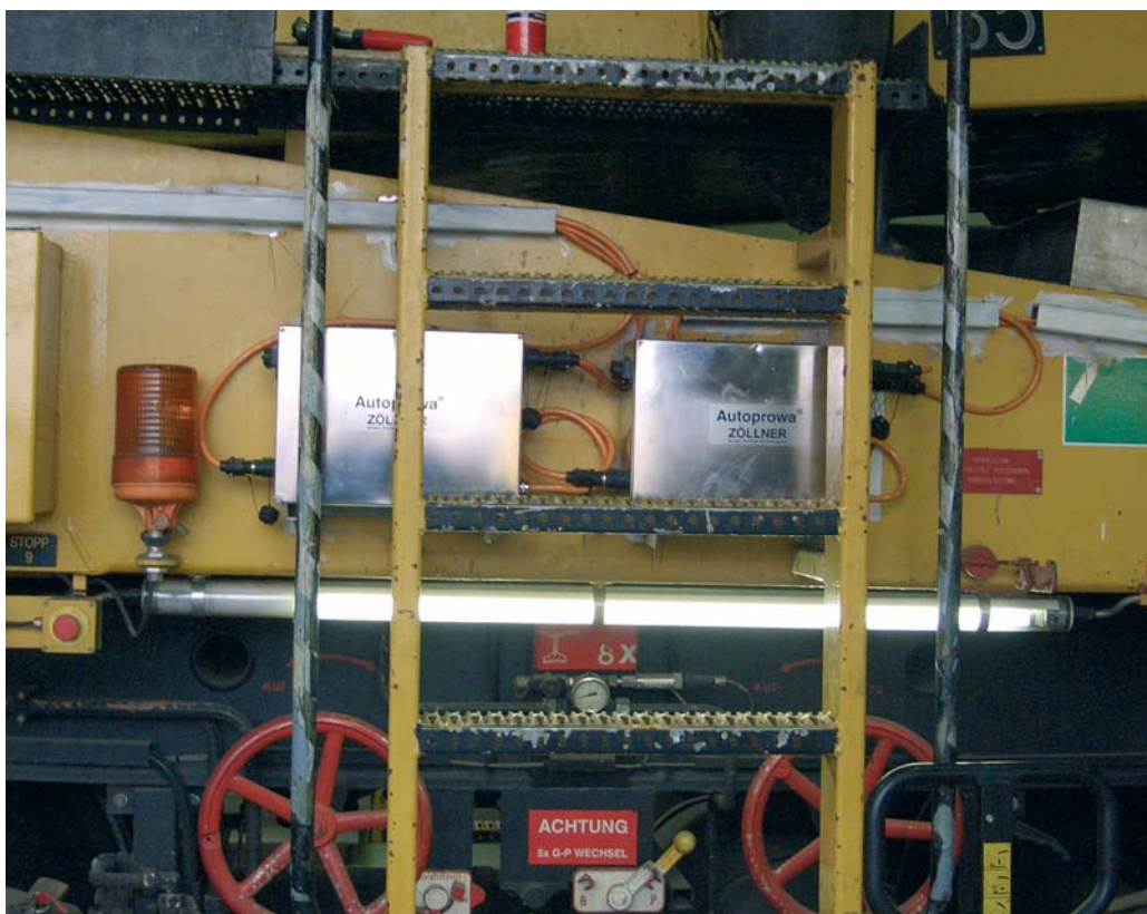
Abbildung 4: Steuereinheiten WGH-M für die Schallwandler servicefreundlich und sicher montiert.
