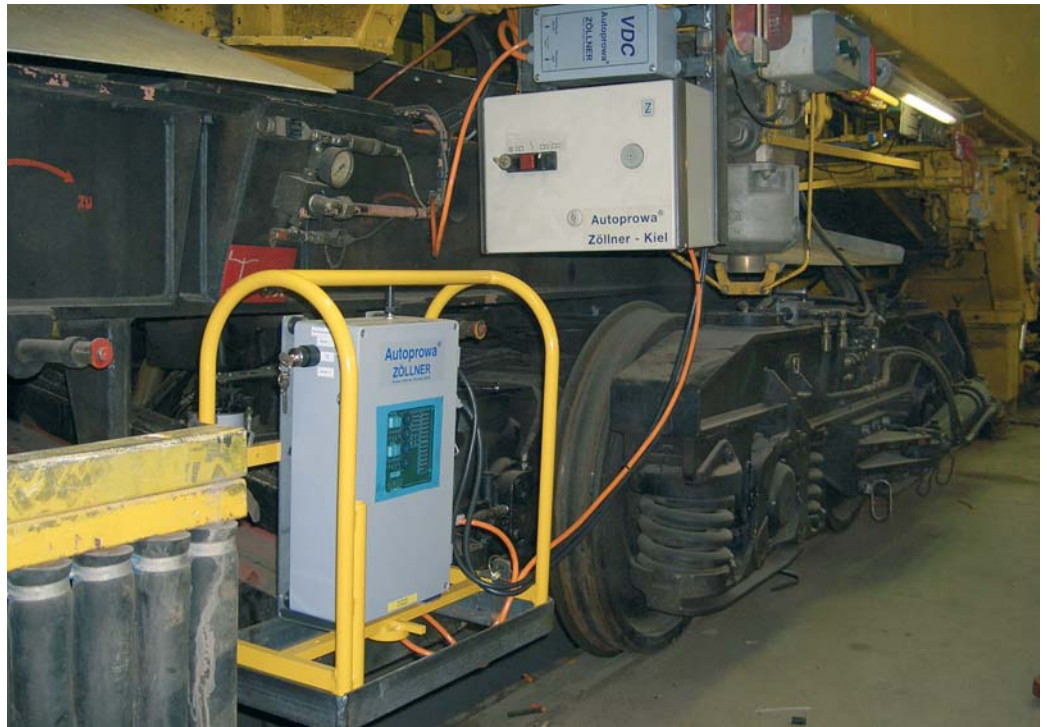
Abbildung 5, oben: ERRI-Schnittstelle ZES mit Span- nungsversorgung VDC und Funk- empfänger ZFE.
