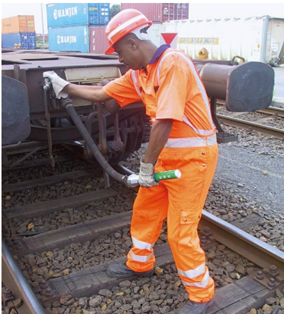
Abbildung 7: Tragbare Schalldämpfer verringern die Lärmbelastung bei der Durchgangsprüfung der Hauptluftleitung.
