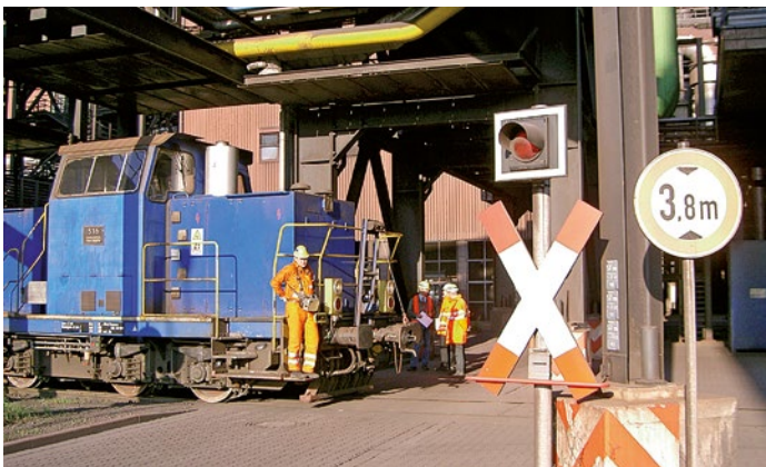
Abbildung 8: Durch die technische Sicherung dieses Bahnübergeweges kann auf das Abgeben von Typhonsignalen zur Warnung anderer Verkehrsteilnehmerinnen und -nehmer verzichtet werden.
