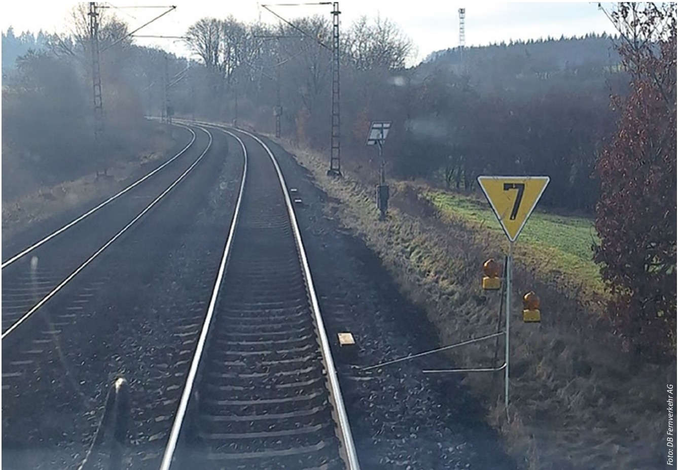
Abbildung 3: Ankündigung einer vorübergehenden Langsamfahrstelle mit 70 km/h durch das Signal Lf 1. Neben der rechten Schiene ist der PZB GM 1.000 Hz erkennbar, der mit dem Betätigen der PZB-Wachsamkeitstaste zu bestätigen ist
