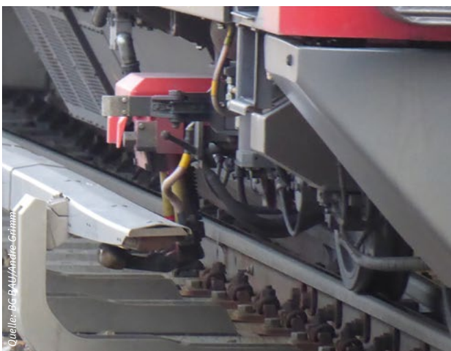
Abbildung 2: Stromabnehmer sind auf beiden Seiten der S-Bahn-Fahrzeuge vorhanden
