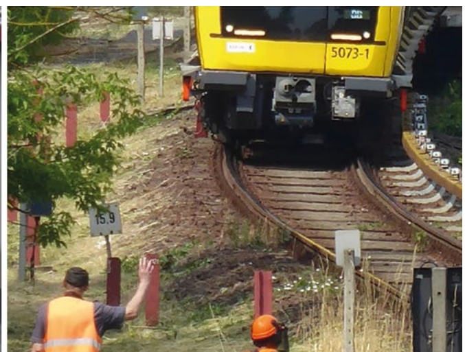
Abbildung 2: Stromabnehmer sind auf beiden Seiten der S-Bahn-Fahrzeuge vorhanden
