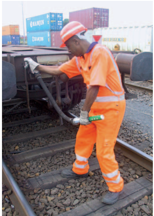
Abbildung 7: Tragbare Schalldämpfer verringern die Lärmbelastung bei der Durchgangsprüfung der Hauptluftleitung.
