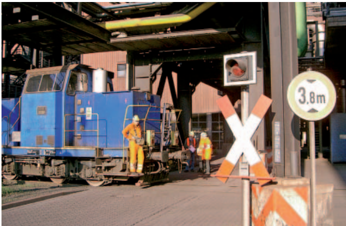
Abbildung 8: Durch die technische Sicherung dieses Bahnüberweges kann auf das Abgeben von Typhonsignalen zur Warnung anderer Verkehrsteilnehmerinnen und -nehmer verzichtet werden.
