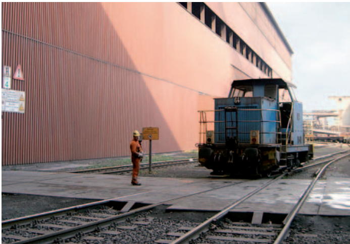
Abbildung 1: Soweit an Bahnübergängen in abgeschlossenen Werksbereichen zu deren Sicherung Typhon- oder Läutesignale abgegeben werden müssen, führt dies zu erheblichen Lärmbelastungen für den Lrf.
