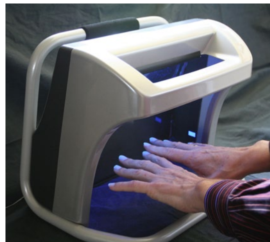
Abb. 4-15 Testgerät (UV-Lampe) zur Überprüfung des Hautschutzes
