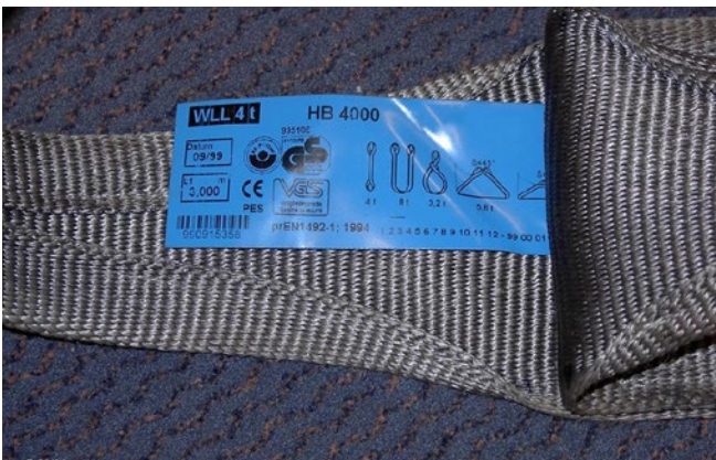
Abb. 27 Hebeband mit Kennzeichnung
