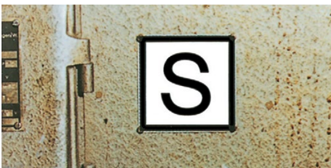
Abb. 25 Kennzeichnung der Schweißstromquelle für den Einsatz in Bereichen mit erhöhter elektrischer Gefährdung
