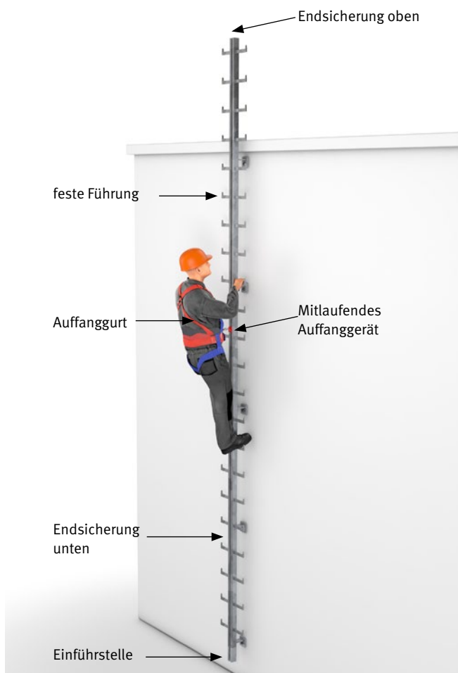
Abb. 42 Beispiel einer Steigschutzeinrichtung
