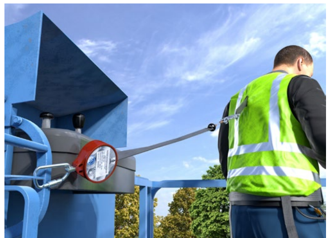
Abb. 17 Benutzung von PSA gegen Absturz in einer Hubarbeitsbühne
