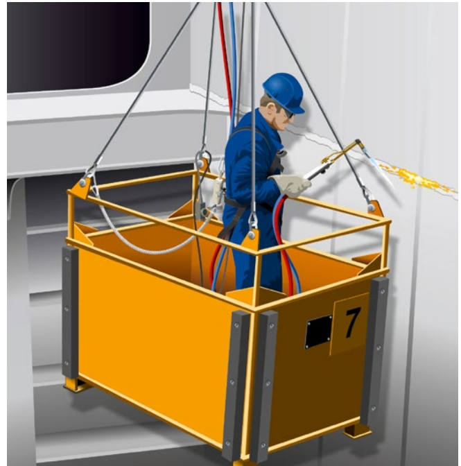
Abb. 15 Hochziehbares Personenaufnahmemittel am Kran hängend
