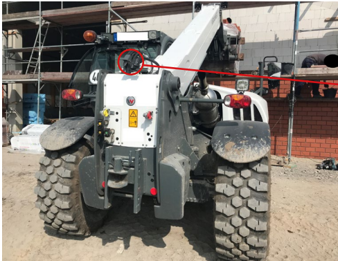
Abb. 8.4 Kamera für Sicht vor dem Anbaugerät eines Teleskopstaplers
