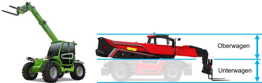
Abb. 5.1 Starrer Teleskopstapler (links), drehbarer Teleskopstapler (rechts)
