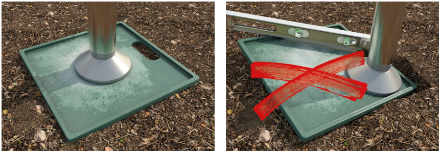
Abb. 8.7 Abstützung mit Unterlegplatten (links: mittig, rechts außermittig)
