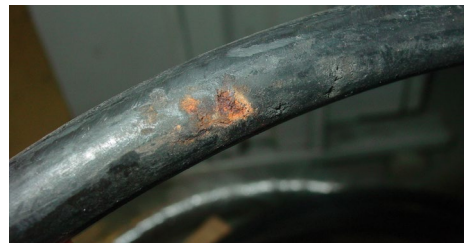
Abb. 10.1 Defekte Hydraulik-Schlauchleitungen sofort ersetzen
