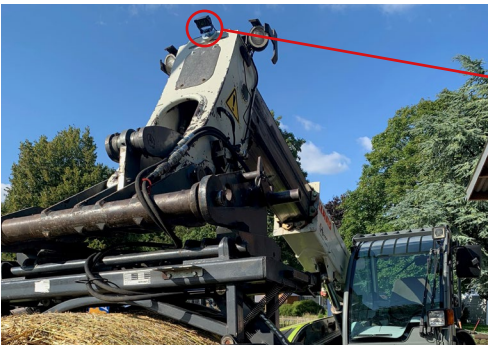
Abb. 8.6 Kamera für Sicht vor dem Anbaugerät eines Teleskopstaplers
