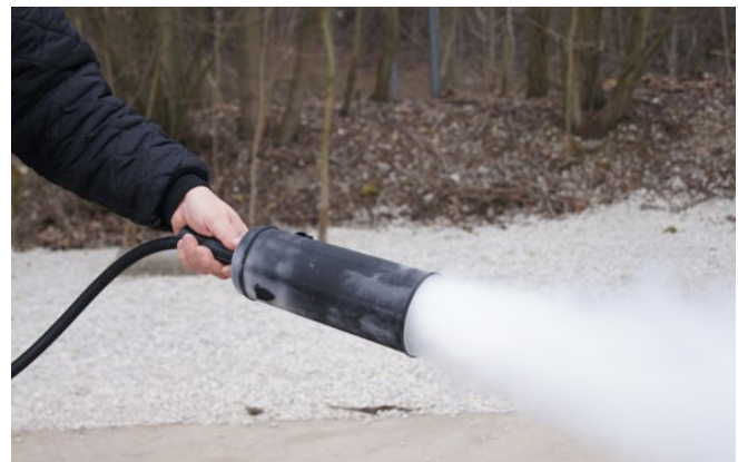
Abb. 2 CO 2 -Feuerlöscher mit Schneerohr / Ausströmen von „CO 2 -Nebel“
