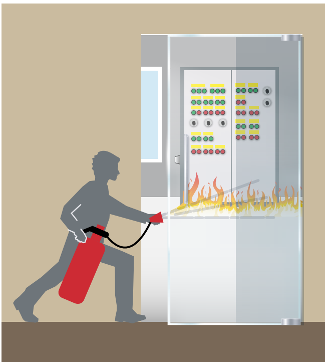
Abb. 9 Löschen durch den Türspalt
