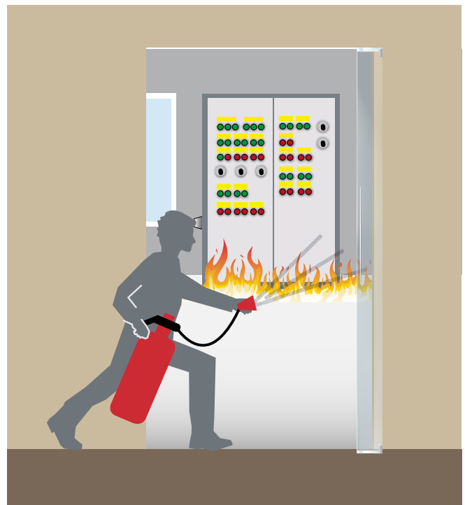
Abb. 10 Löschen durch die geöffnete Tür
