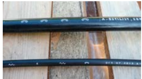
Abb. 8 Kupferkabel (oben) und Glasfaserkabel
