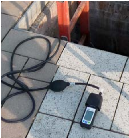
Abb. 1 Messgerät zum Freimessen von Kabelschachtanlagen
