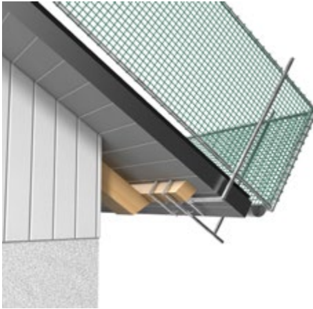
Abb. 12 Seitenschutzsystem mit Klemmpfosten und Schutznetzen
