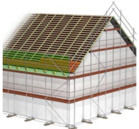
Abb. 10 Beispiel für Seitenschutz am Ortgang in Verbindung mit einem Standgerüst
