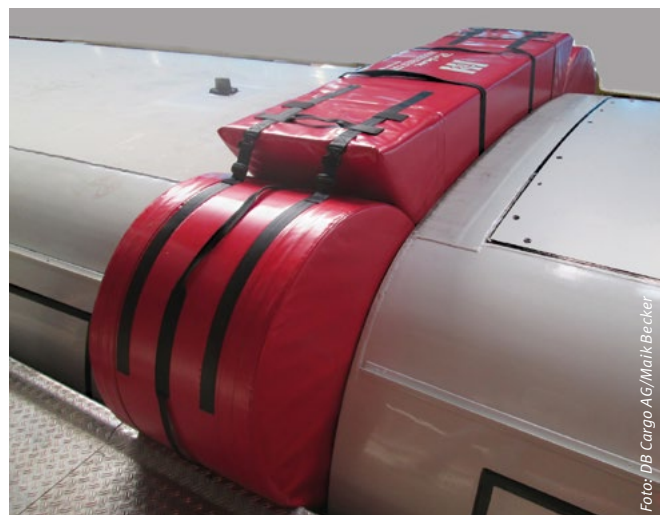
Abbildung 2: Spaltabdeckungssystem mit durchsturzsicheren Formkörpern
