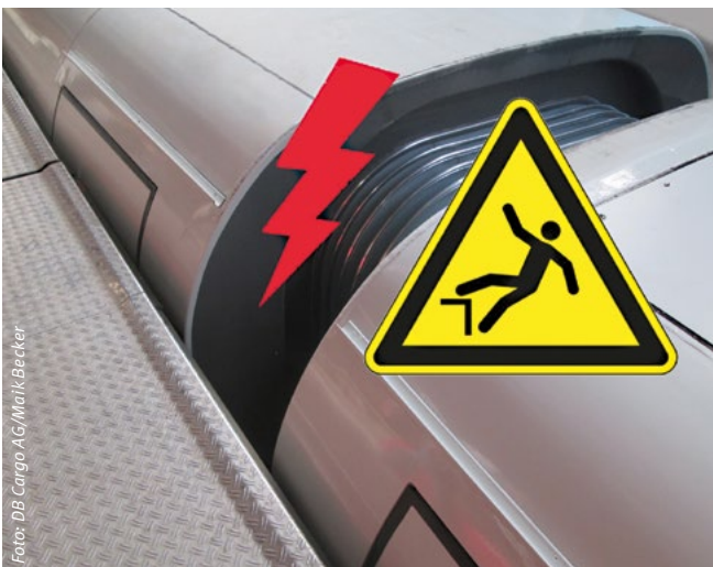
Abbildung 1: Absturzgefahr zwischen den beiden Wagenkästen
