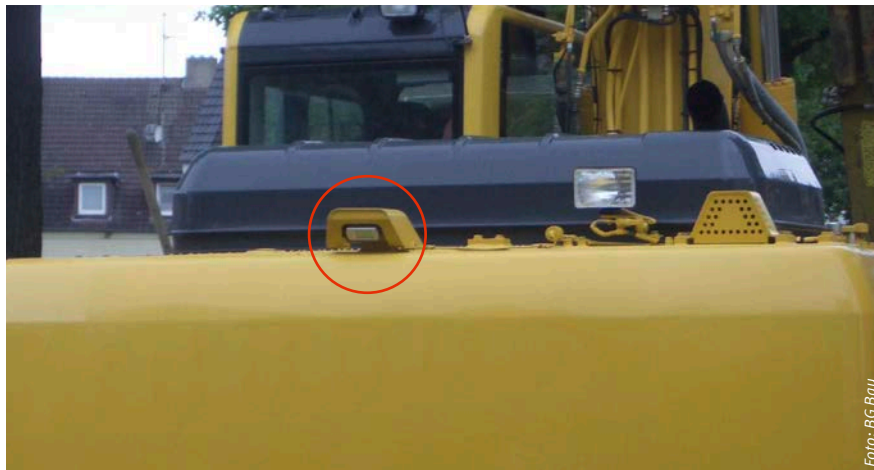
Kamera der Rückraumüberwachung am Bagger
