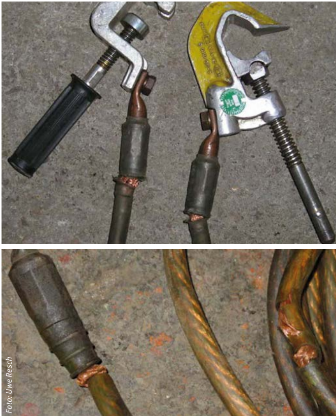
Abbildung 2: Diese Vorrichtungen dürfen nicht mehr eingesetzt werden
