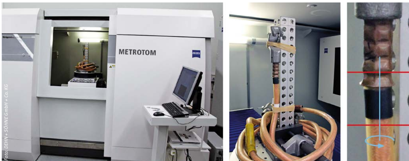
Abbildung 7: 3D-Computertomografie Messaufbau, rechts: in rot der Messbereich, in blau die Drehachse
