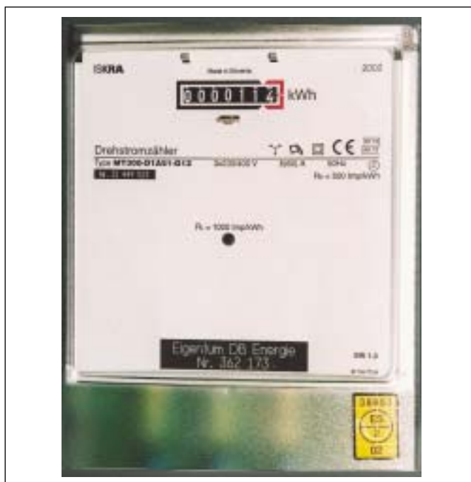
Bild 1: Vierleiter-Drehstromzähler für Direktanschluss. Die LED mit der Impulswertigkeit R_L = 1000 \text{ Imp/kWh} ist für die Prüfung des Zählers von Bedeutung. Sie entspricht der Zählerkonstante (z.B. U/kWh), bei Induktionszählern. R_A = 500 \text{ Imp/kWh} ist die Wertigkeit des S0-Ausganges.
