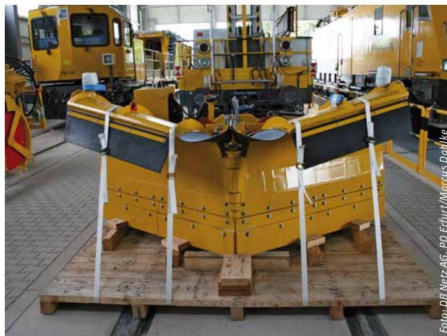
Abbildung 2: Schneepflugaufsatz für die BR 705.2
