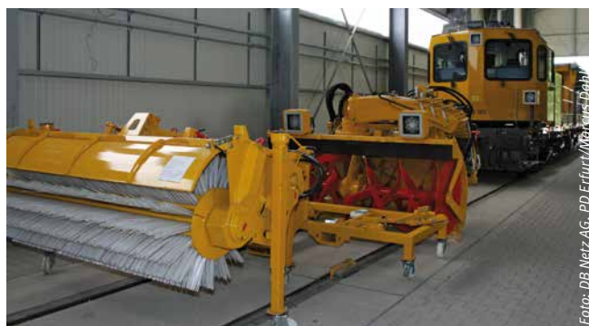
Abbildung 3: Schneefräßschleuder und Kehrgert Aufsatz für BR 705.2
