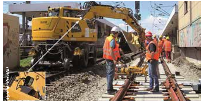
Heck- und Seitenraumüberwachung bei Zweiwegebaggern
