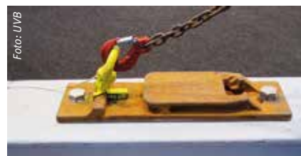
Anschlagmittel zum Anschlagen von Weichenschwellen
