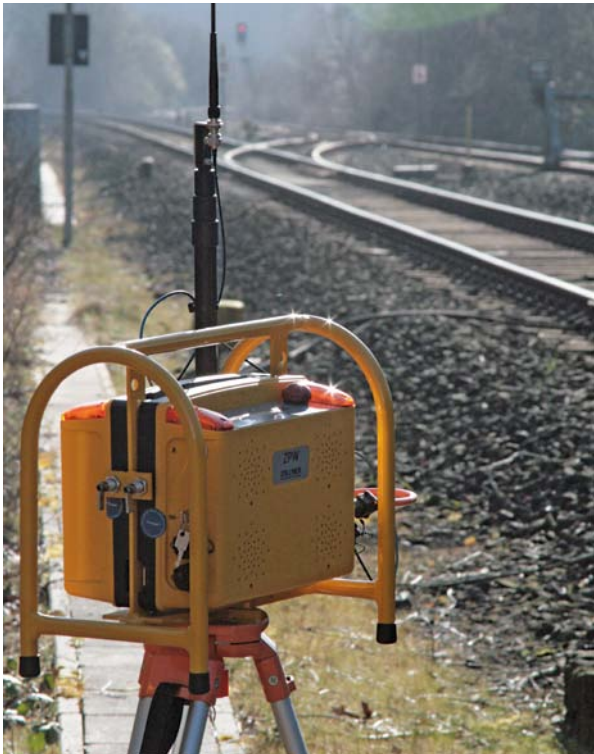
Abbildung 3: Komponente eines bidirektionalen Funkwarnsystems der Fa. Zöllner, Kiel
