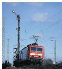
Unser Titelbild: RegionalBahn mit E-Lok der BR 143 mit Einfahrsignal. Foto: DB AG/Rainer Schedler.
