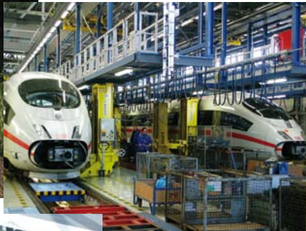
Abbildung 2: ... Arbeitsbühnen mit Spaltbreite „0“ statt Dacharbeiten am Seil...
