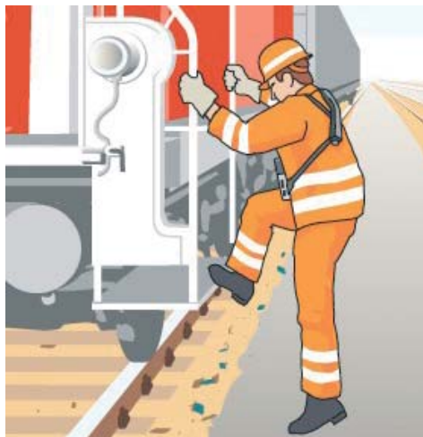
Abbildung 6: Anwendung der „Dreipunkt-Metho- de“ beim Auf- und Absteigen.
