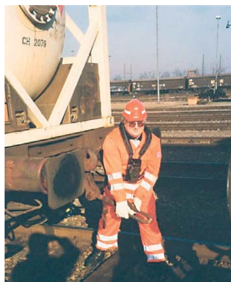
Abbildung 10, oben: Lokrangierführer beobachtet Kuppelvorgang von einem sicheren Standort außerhalb des Gleisbereiches.
