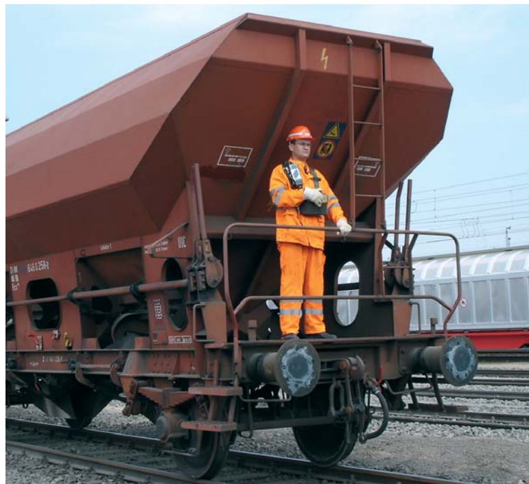
Abbildung 5: Lokrangierführer mittig auf der Übergangs-/Endbühne.
